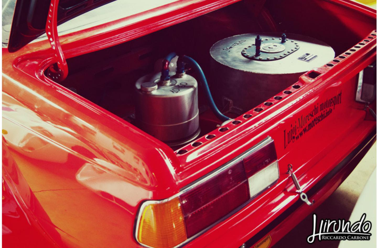
con tanto di carter secco e serbatoio dell'olio nel bagagliaio.
